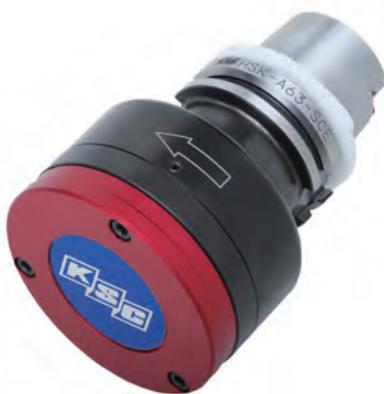
「スピクリン」は工作機械や生産ラインに組み込むことで、主軸端面に付着した微細な切りくずや異物が取り除けるクリーナー。機械主軸に取り付けて増速後に急停止すると、接触式のワイパーが慣性力で回転し、自動的にクリーニングする。クリーニング時間は5秒程度のため、サイクルタイムに与える影響も少ない。
