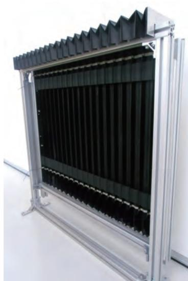
ナベルの「異常ストローク検知機能付ジャバラ」は、工作機械の駆動部を切削粉や油などから防護するジャバラにリード線を組み込み、伸縮の異常をセンサーで検知し全体の動作を停止させる安全機能を持たせた。動作中にジャバラが一定の長さ以上に引っ張られると、本体に取り付けたリード線も伸びて断線。それをセンサーが検知するという仕組みだ。
