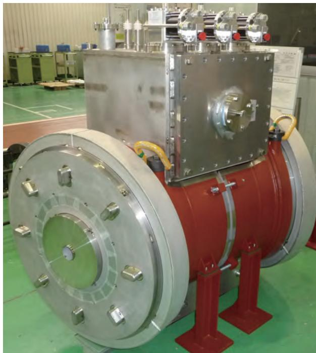
に比べ強力な磁場を作り出せるようにした。ビーム軌道半径を縮小し、分離していたビーム偏向・収束機能も統合。偏向・収束に必要な電磁石をそれぞれ独立設置する必要をなくした。ビーム輸送ラインの設置長さも大幅に短縮した。
