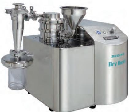
卓上型乾式粉碎機「ドライバースト・ミニ」用粉碎ユニットは毎分2万回転で旋回するインペラ（プロペラ）により生じる高速気流で材料同士を衝突させる。原料を $5\mu\text{m}$ 以下に粉碎する。粉碎室や対向気流形状を工夫したことで、能力が従来機比40%向上した。
