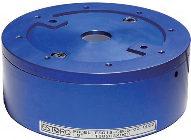
静電容量式の同センサーは、円環板形状の部品を3層重ねて接合したシンプルな構造。外側の円環である受力体にトルクがかかった時に中央の起歪体が変化する。その変化量を、センサー内部に配置した4対の電極による静電容量の変化から検出する仕組みだ。
