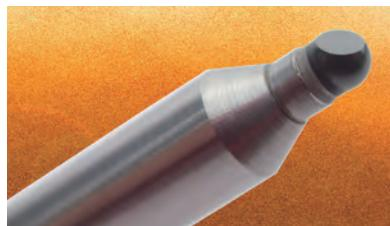
ダイヤモンド焼結体(PCD)を素材に使ったエンドミル。超硬合金やセラミックスなどの硬脆材料の超精密切削加工に加え、ダイヤモンド工具では不可能とされてきた鉄鋼材料の超精密仕上げ加工を可能にした。ナノメートル単位の鏡面にでき、従来比10倍以上という工具寿命を実現した。
