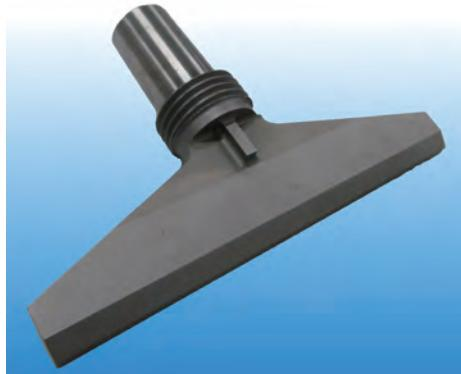
割れやすいガラスなどと金属部材の超音波接合を可能にするチップ部品。接合部材に超音波振動を与える部分の部品で、従来品の10倍以上となる75mmのチップ幅が特徴だ。超音波接合装置に搭載することで、太陽電池パネルのガラス基板上に電極を直接接合できるようになる。
