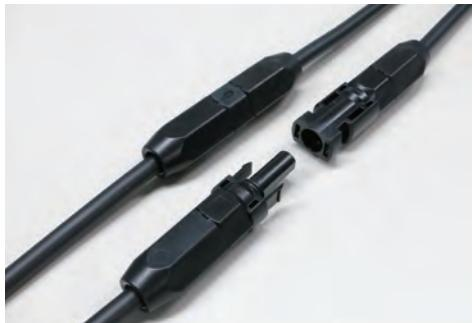
太陽電池モジュールとパワーコンディショナー（電力調整装置）を電力ケーブルで接続する場合などに用いる。電力ケーブルを接続する際にははんだ付けや、専用工具を使って内部の端子を圧着する必要がある。仕上がりによっては接続不良を起こしやすいという問題があった。同製品はホルダーの刻印に合わせてケーブルの絶縁体をカットし、シェルとホルダーにケーブルを差し込み、スパナで締め込むだけで接続可能。密閉性が高く、防水性に優れる。導体面積が $3.5\text{mm}^2$ – $5.5\text{mm}^2$ の一般的な電力ケーブルに使用できる。
