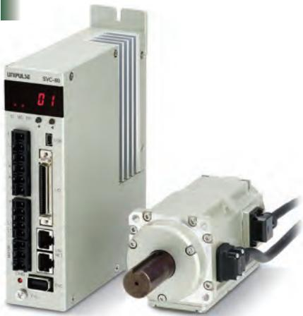
出力軸のトルクを測定・制御できる減速機付きサーボモーターで、トルクメーターを出力軸に組み込み、専用コントローラーでモーターとトルクを一体的に制御できる。トルクをゼロにして、モーターとつながる動力系統を手で簡単に動かせる。ロボットアームを手で動かして作業を教え込むダイレクトティーチングにも応用可能。
